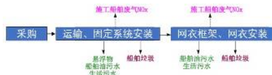
图 2.2-1 施工期工艺流程及产污环节
